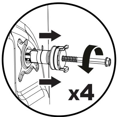
Транспортировочные болты должны быть удалены путем вытягивания. Удаленные транспортировочные болты следует сохранить для повторного использования в случае возникновения необходимости в повторной транспортировке, например, при переезде.
