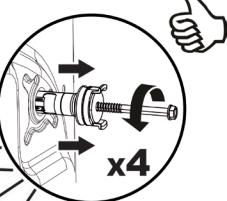
Транспортировочные болты необходимо вывинтить, вращая их против часовой стрелки с помощью подходящего ключа.
