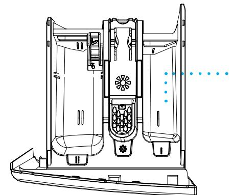
**Главный отсек моющего средства для стирки:** В этом отсеке используются только жидкие моющие средства и стиральные порошки или хлоросодержащие средства. Устройство для жидкого моющего средства находится внутри машины, вы можете найти его там при выполнении первичной настройки. (\*)
