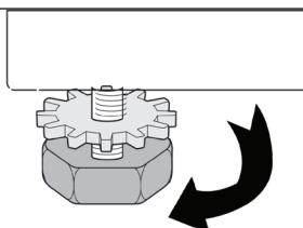
Вы можете отрегулировать равновесие машины с помощью регулируемой ножки.
